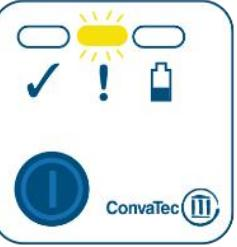
Желтая индикаторная лампочка “!” загорается в тех случаях когда в систему проникает воздух и терапия отрицательным давлением не производится.
